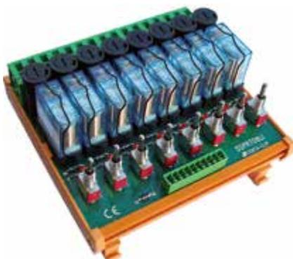
Für die automatisierte Steuerung wie z.B. Beleuchtung und Jalousien in Gebäuden haben wir dieses Produkt entwickelt. Das System besteht aus Relais- und Bypass-Modulen, die die Signale einer SPS oder PLC s auf 4 Gruppen à 8 Signale weiterleiten.
